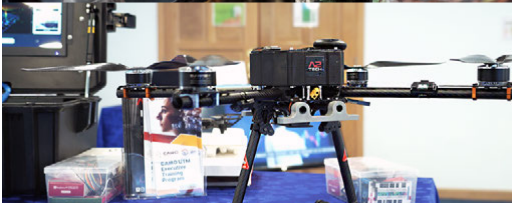
Dron yang digunakan bagi merekod imej kanopi Hutan Pasoh secara masa nyata
