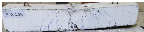
Figure 17. Beam P.O.1.0% Failure
